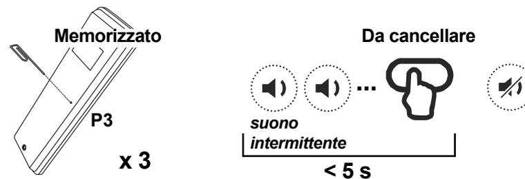
Premere **3 volte** il tasto **P3** del trasmettitore **memorizzato**. Il buzzer emette un suono intermittente lento. Premere il tasto relativo al codice **da cancellare** entro 5 secondi. All'avvenuta cancellazione il buzzer smetterà di suonare.
