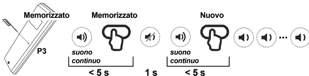
Premere per il tasto **P3** del trasmettitore **già memorizzato**. Il buzzer emette un suono continuo. Premere il tasto relativo ad un codice **memorizzato**. Il buzzer si ferma per 1 secondo e riprende il suono continuo. Premere il tasto relativo al **nuovo** codice. All'avvenuta memorizzazione il buzzer emette un suono intermittente veloce.
