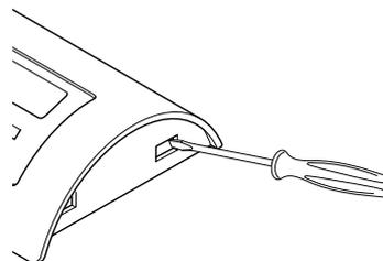
Presser sur les ergots latéraux afin d'ouvrir le capot arrière
