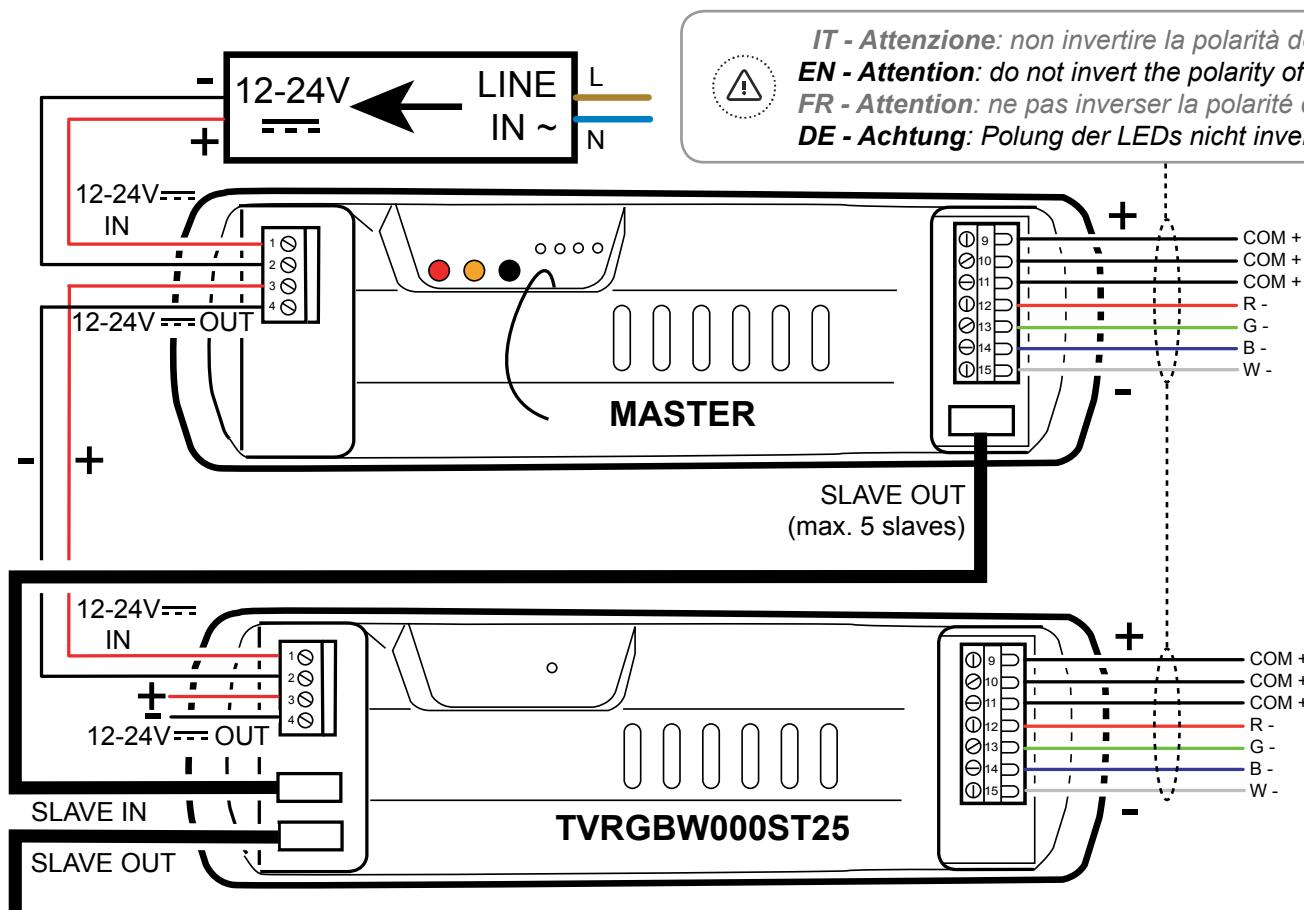
**IT - Attenzione:** l'alimentazione fornita al dispositivo deve corrispondere al voltaggio del carico!
